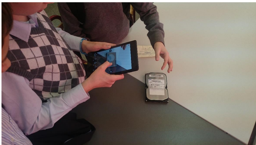
Рисунок 33 – 3D-модель жесткого диска накладывается с помощью устройства дополненной реальности на реальный объект
